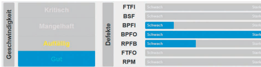
Fig. 7 Dashboard zur schnellen Übersicht des Zustands einer Komponente, Beispiel Wälzlager: aktuelle Bewertung des Schwingungspegels gemäss ISO 10816 (links), aktuelle Ausprägung der möglichen Lagerdefekte (Zustand) aus der defektbasierten Anomaliedetektion (rechts).
